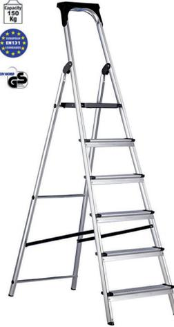
Escalera de tijera peldaño ancho y una subida provista de plataforma y guardacuerpo. Ideal para uso doméstico resistente y estable. En aluminio anodizado no ensucia las manos del usuario y está construida remachando los peldaños a los montantes (6 remaches cada peldaño) obteniendo una rampa de ascenso resistente y estable. La apertura accidental es impedida por dos dispositivos: plataforma autobloqueante y cintas de seguridad.
